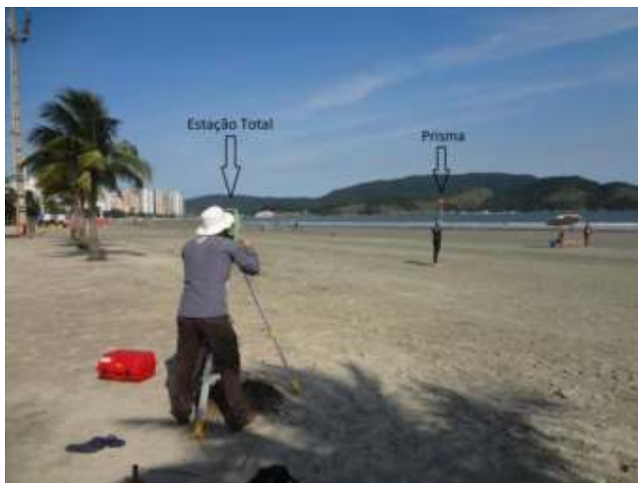
Figura 57. Levantamento topográfico utilizando Estação Total. Fonte: acervo pessoal, maio 2015.
