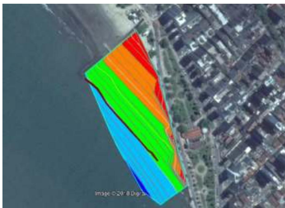
Figura 72. Sobreposição da linha de costa corrigida da imagem do Google Earth® ao MDE do levantamento de campo
