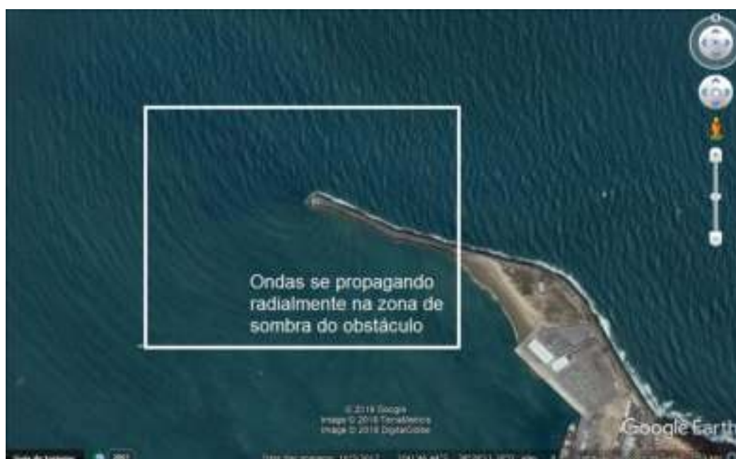
Figura 3. Difração das ondas ao passarem pela obra de abrigo do Porto de Mucuripe em Fortaleza, Ceará - Brasil. Fonte: adaptado de Google Earth, ©2015 Google Inc.
