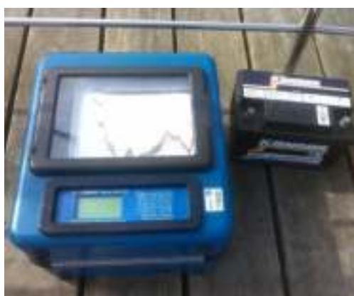
Figura 58. Ecobatímetro utilizado para coleta de dados de campo. Fonte: acervo pessoal, setembro 2016.
