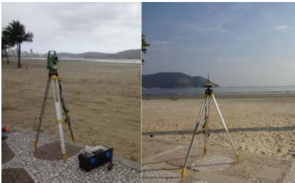
Figura 53. Estação total (à esquerda) e equipamento GNSS (à direita). Fonte: acervo pessoal, maio, 2014.
