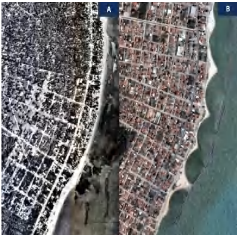
Figura 1. Fotografia da zona costeira do município de Paulista, no estado de Pernambuco, em 1974 (A) e em 2004 (B) depois da implantação dos quebra-mares. Fonte: ITEP, 2012.
