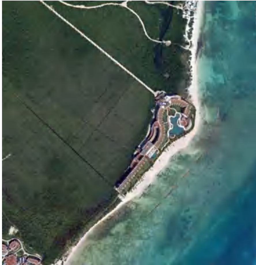
Figura 18. É possível notar o alargamento na praia na região em que houve a implementação dos quebra-mares, entretanto sem saliências proeminentes. Fonte: Adaptado de Lopez, 2014.
