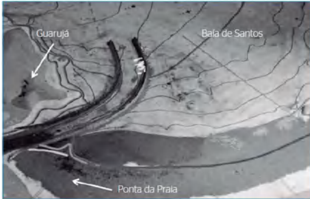
Figura 24. Tendência de evolução da linha de costa na região da Ponta da Praia, obtida durante ensaio em modelo físico. Fonte: Gireli et al., 2018.
