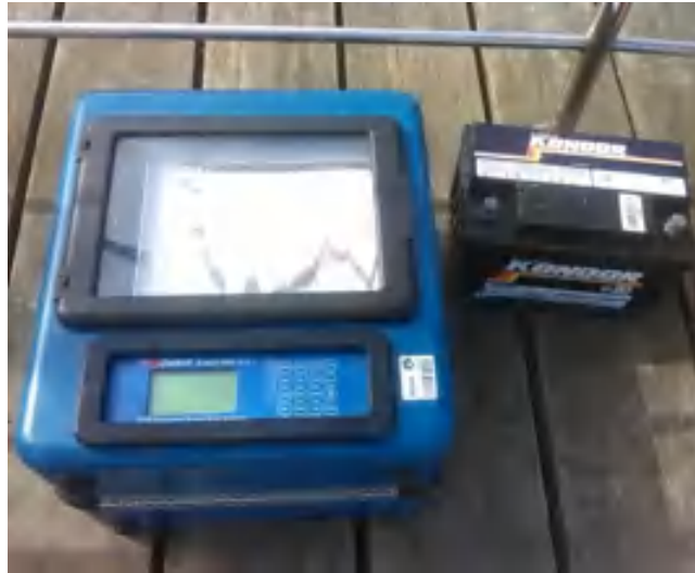
Figura 33. Ecobatímetro utilizado para levantamento dos dados batimétricos. Fonte: Venancio, 2018.
