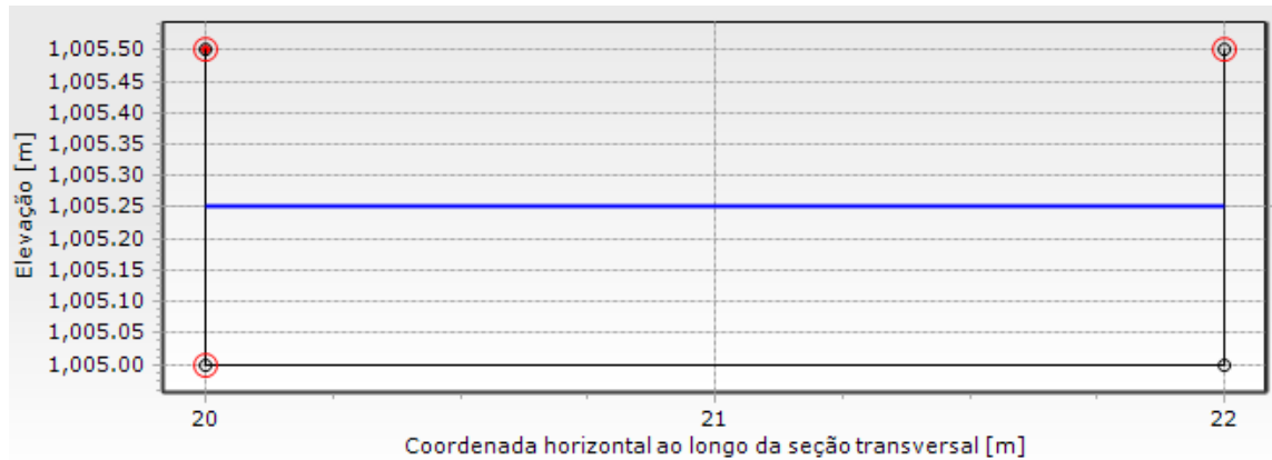
Figura 24 - Seção transversal da cadeia 0 m do rio Vargem do Braço no MIKE 11.
