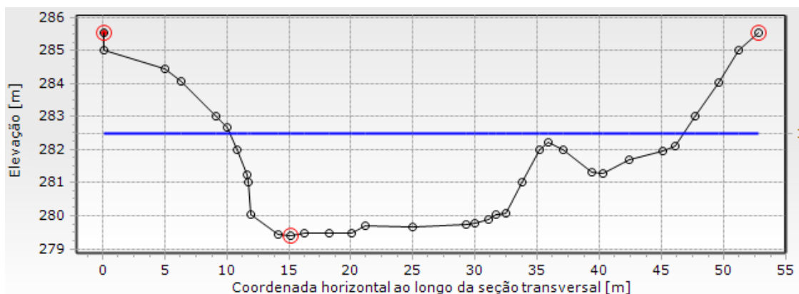
Figura 23 - Seção transversal da cadeia 19920 m do rio Vargem do Braço no MIKE 11.
