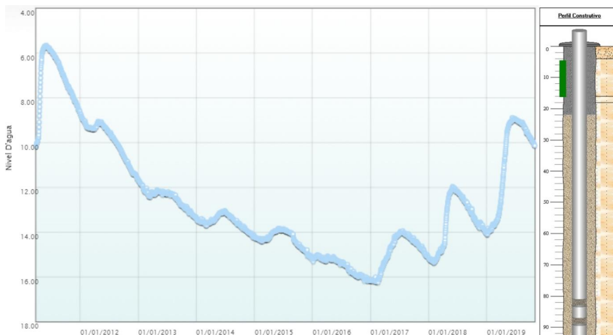
Figura 3.7: Monitoramento do nível d'água no poço RIMAS e perfil geológico construtivo.
